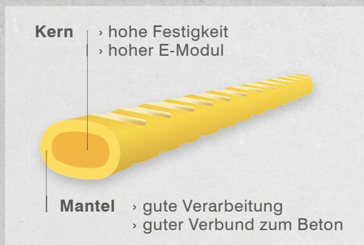
Bei Concrix handelt es sich um eine einzigartige, bicomponente Kunststofffaser mit strukturierter Oberfläche. Der Faserkern garantiert dank hohem E-Modul **höchste Festigkeitswerte**, der spezielle, strukturierte Mantel wiederum stellt den **exzellenten Verbund zum Beton** sicher.
